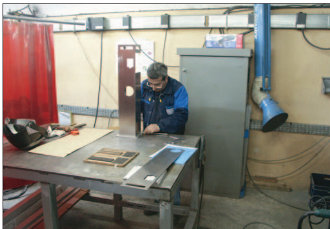
▲ Auxiliaire de Ferblanterie réalise des ensembles de tôlerie complets, comportant de nombreuses opérations au-delà de la découpe. L'assemblage par soudage est ici facilité par la précision des pièces.
