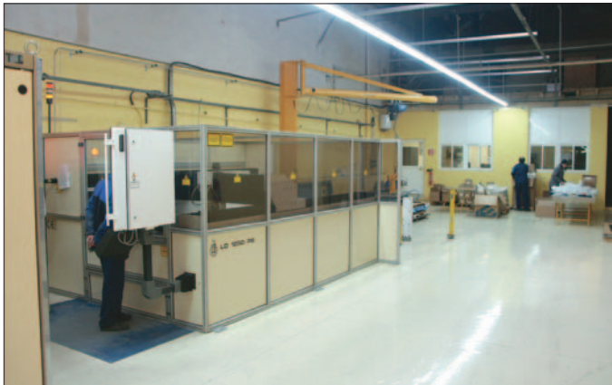
▲ La nouvelle installation de découpe laser LD 1250 PS a été installée dans un hall entièrement rénové, afin de mettre en valeur cette machine hautement performante.
