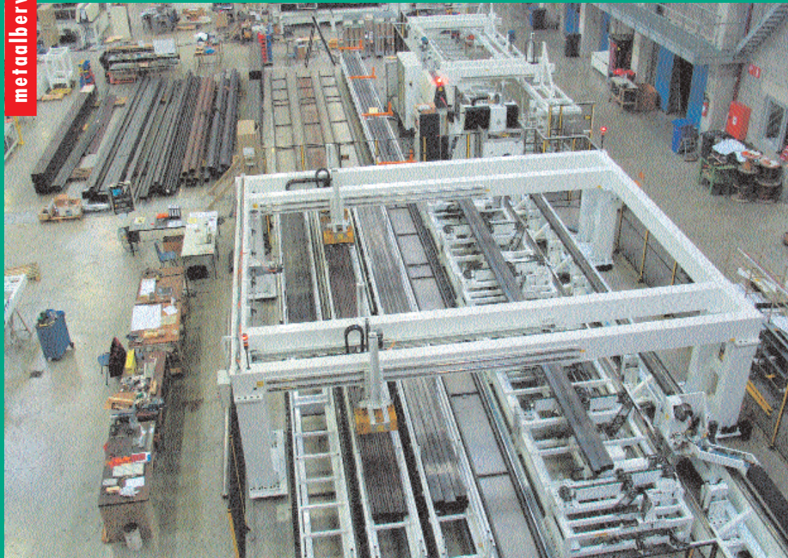
■ De gigantische buislaser heeft een lengte van 31,5 m en een breedte van ruim 9 m. Het werkbereik is niet minder dan 13,2 m (foto's: Andersom)
