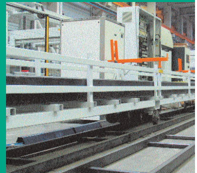
■ Met behulp van vier cassettes worden de profielen en teem gereden
