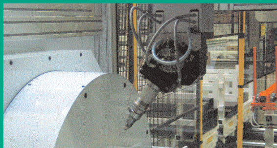
■ De NC-gestuurde tiltkop van de buislaser maakt het mogelijk om zelfs de grotere en dikere profielen onder een hoek te snijden
