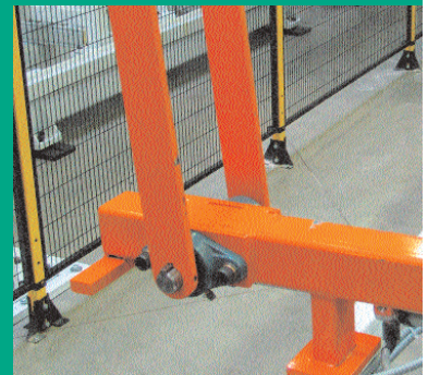
■ Voor de ronde buizen is een speciale inlegtafel ontworpen die is gemonteerd
