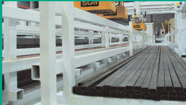
■ Vier krachtige magneten tillen de profielen per rij uit de cassettes en plaatsen ze op een kettingtransporteur
