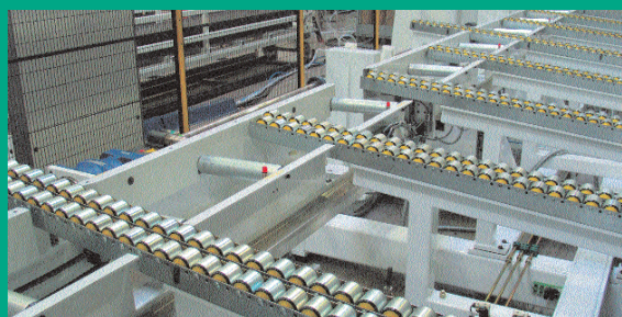
■ Via een aantal korte rollenbaantjes worden de gesneden buizen en profielen naar een lange aangedreven rollenbaan getransporteerd
