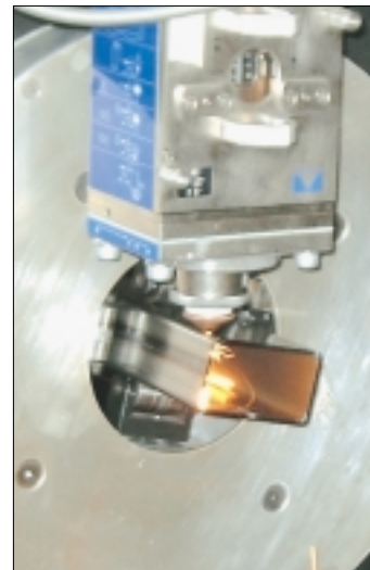
De ondersteuning en klemelementen passen zich immers telkens aan de vorm van het te verwerken profiel aan, zowel ronde als niet-ronde secties
