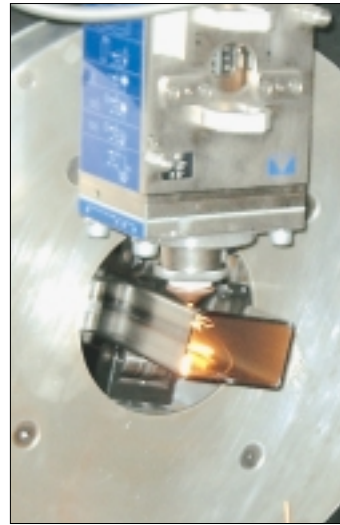
Les supports et les éléments de serrage s'adaptent, en effet, à chaque fois à la forme du profilé à usiner, aux sections rondes comme non rondes
