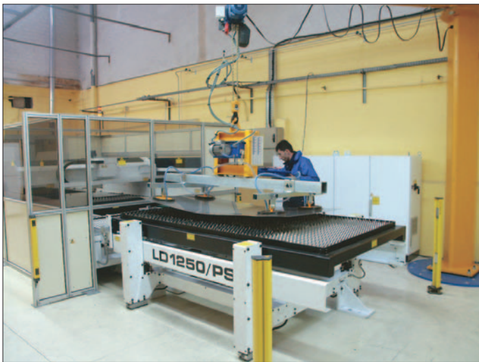
▲ La nouvelle installation de découpe laser LD 1250 PS fournie par Balliu est dotée de 2 tables de découpe et d'un dispositif d'échange des palettes qui permet de réaliser le chargement et le déchargement en temps masqué.
