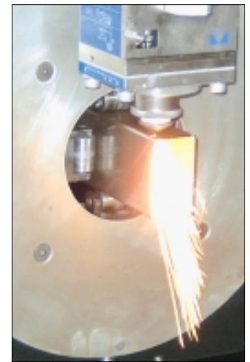
Les supports et les éléments de serrage s'adaptent, en effet, à chaque fois à la forme du profilé à usiner, aux sections rondes comme non rondes
